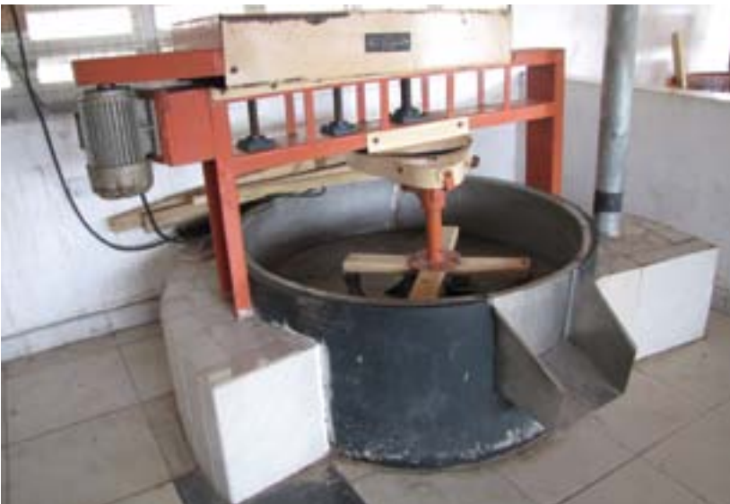
Torréfacteur automatique, idéal pour produire de grandes quantités de gari
