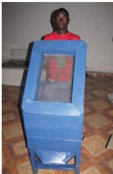
Un tamis pour gari en treillis d'acier inoxydable
