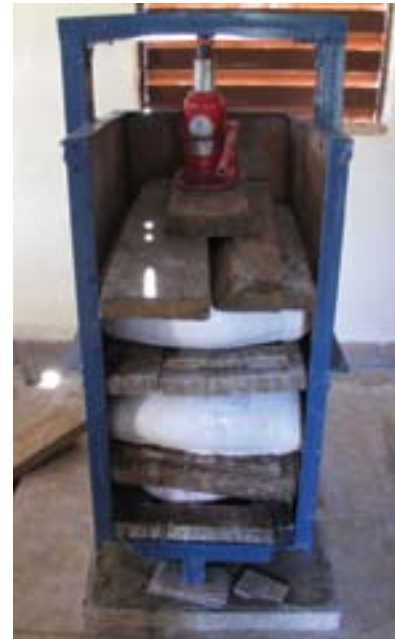
Presse hydraulique utilisée pour extraire l'excès d'eau de la pâte de manioc
