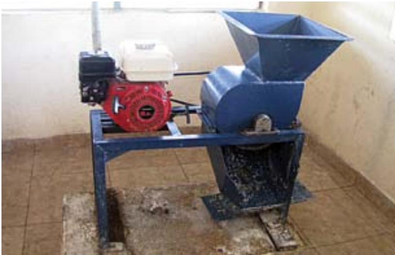
Râpeuse motorisée utilisée pour écraser les racines de gari et en faire une pâte humide
