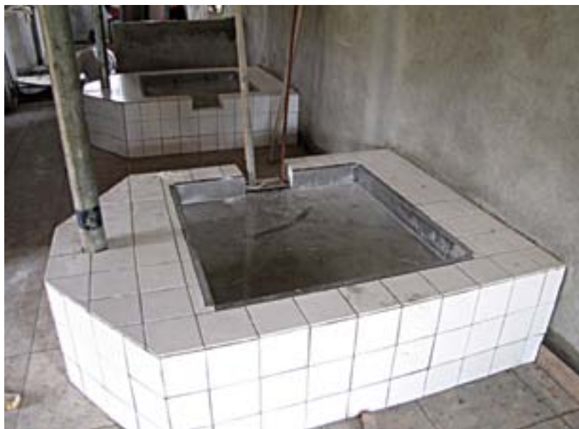
Une aire de grillage de gari avec un plateau d'acier inoxydable peu profond ou récipient en aluminium moulé. Le plateau doit être monté sur des briques de terre qui ont un meilleur rendement calorifique plutôt que sur des briques en ciment. La bordure du plateau doit être carrelée pour que la surface reste propre.
